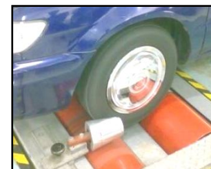
Gambar 2. Skema pengujian torsi dan daya mesin
