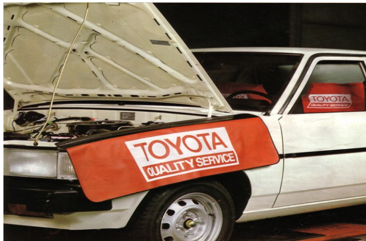
Gambar 3.1 . pemasangan fender , grill dan seat cover kendaraan.
